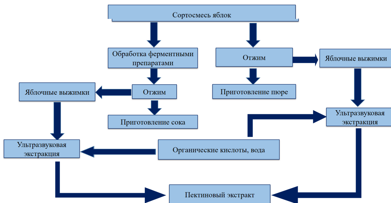
Рисунок 1 – Схема проведения ультразвуковой экстракции.
